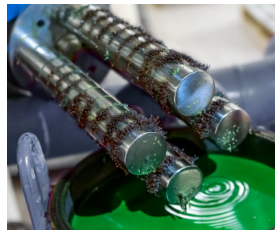
Magnetická vložka v mechanickom filtri účinne zachytáva zvyšok magnetitu z obehovej vody.
